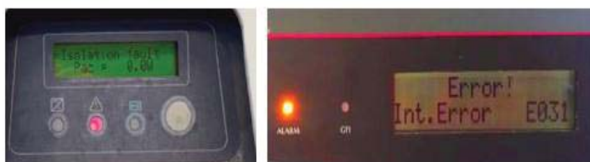
شکل ۸۱- چراغ قرمز - نشانگر عملکرد نادرست اینورتر است
