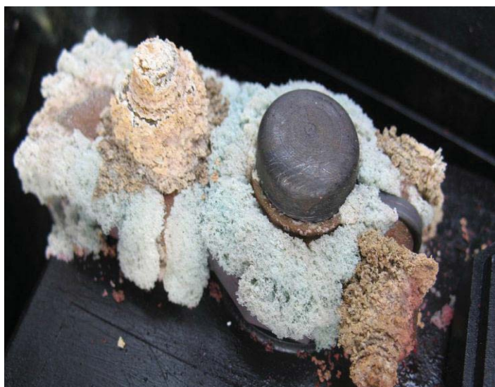
شکل ۹۹- باتری سولفاته شده
