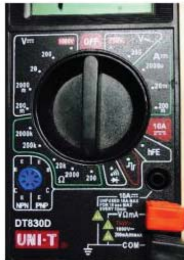
شکل ۱۴۰ - انتخاب صحیح محدوده اهم در مولتی‌متر
