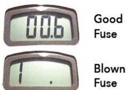
شکل ۱۴۲ - مقدار نمایش داده شده نشان دهنده سالم بودن فیوز یا معیوب بودن آن است.
