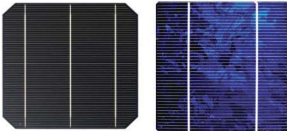
شکل (۶-۲) - نمونه ای از سلول منوکریستال و پلی کریستال سیلیکونی
