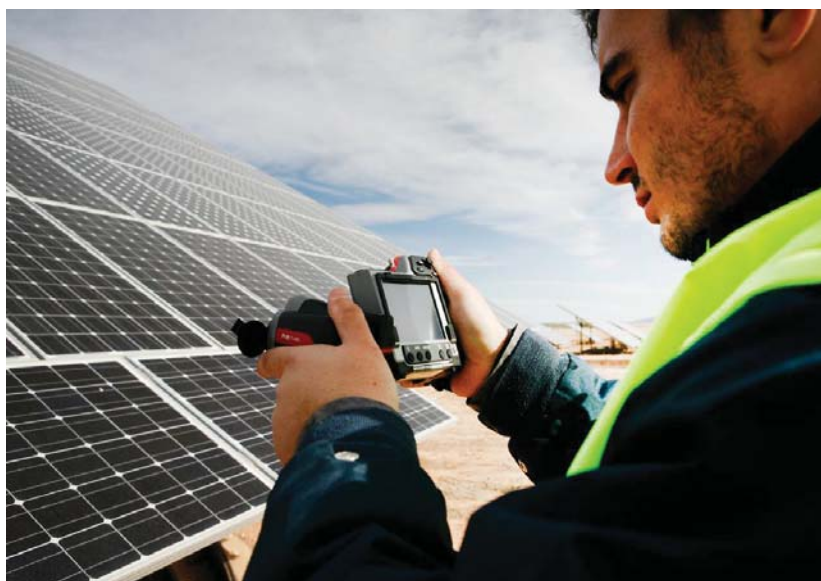
شکل ۶۳ - بررسی پنل‌ها با دوربین
