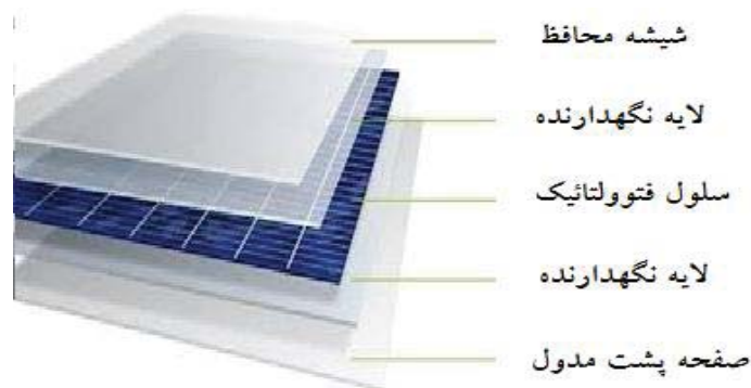
شکل (۶-۱) - بخش‌های تشکیل دهنده مدول فتوولتائیک
