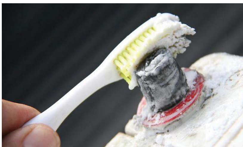
شکل ۱۲۸ - تمیز کردن باتری با جوش شیرین
