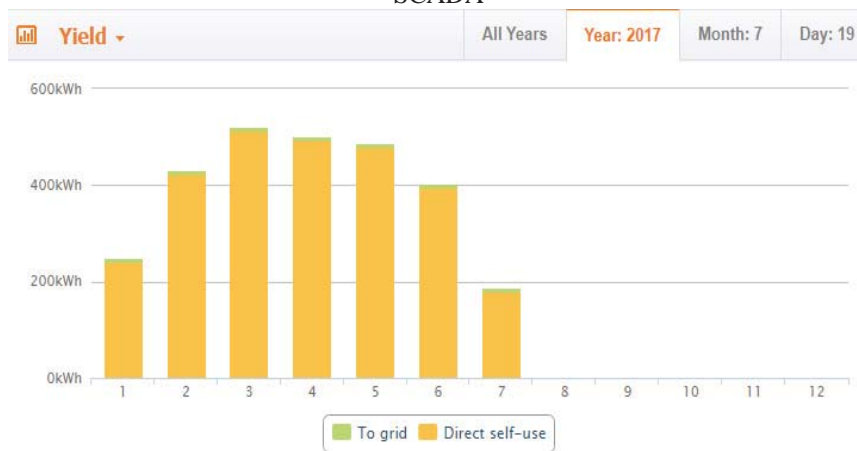
شکل ۱۳۳- نمایش مقدار انرژی مصرف داخلی و مقدار انرژی تزریق شده به شبکه برق توسط
