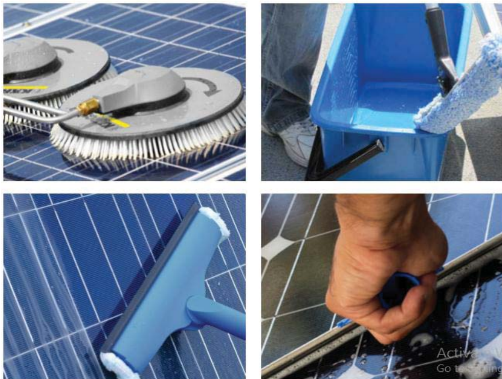
شکل ۴۳- تجهیزات مورد استفاده برای تمیزکاری
